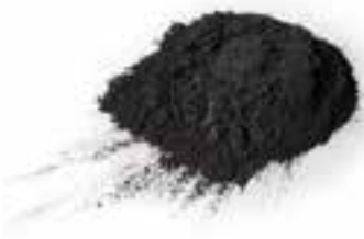
Produit du broyage: poudre de smartphone très fin, prêt à l'analyse
